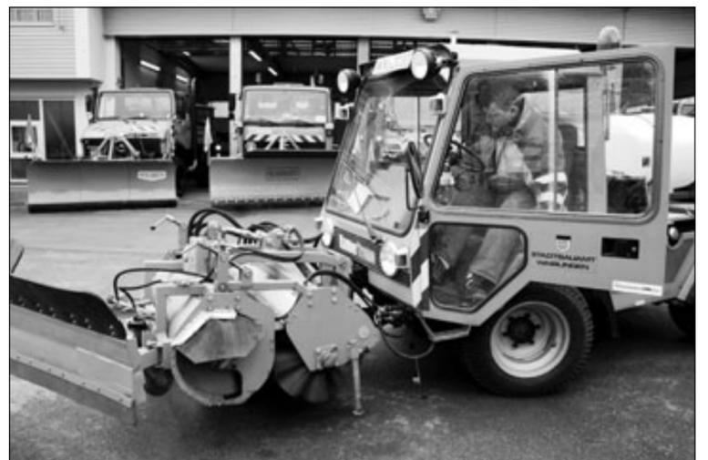
Der Technische Betriebshof der Stadt Waiblingen ist für den Winterdienst gerüstet. 54 Mitarbeiter und elf Fahrzeuge stehen bereit. Als Testfahrzeug soll in diesem Jahr zum ersten Mal auf Geh- und Radwegen ein umgerüstetes, mit Räum-Kehr-Einheit und Tank sowie Sprüheinrichtung für Natriumchloridlösung ausgestattetes Fahrzeug eingesetzt werden (Bild unten). Erhofft werden dadurch intensiveres, schnelleres Schneeräumen, Kostenersparnis und mehr Verkehrssicherheit. Fotos: Redmann
