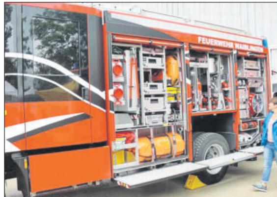
An Bord eines solchen Hilfeleistungs-Löschfahrzeugs befindet sich eine außerordentlich reichhaltige Ausrüstung, die für annähernd alle Einsatzsituationen verwendet werden kann. Das Allzweckfahrzeug wird für die Menschenrettung eingesetzt, für die Brandbekämpfung, bei Verkehrsunfällen oder auch bei Sturm und Wasserschäden.
