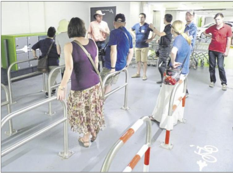
In Ebene 1 der Marktgarage sind acht Pedelec-Stellplätze mit Lademöglichkeit eingerichtet. In den Schließfächern kann während des Abstellens der Akku sicher verstaubt und gleichzeitig geladen werden. Fotos: Redmann
