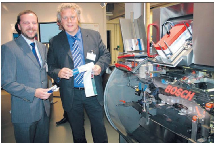
Dipl.-Ing. Uwe Stroinski, Abteilungsleiter bei Bosch Packaging Technology, und Reinhard Rapp von der Produktentwicklung Kartonierer innerhalb der Packaging Technology der Firma Bosch zeigen an einer Universalkartoniermaschine für die Verpackung von pharmazeutischen Geräten, wie das Produkt in eine Schachtel samt Beipackzettel verpackt wird.
