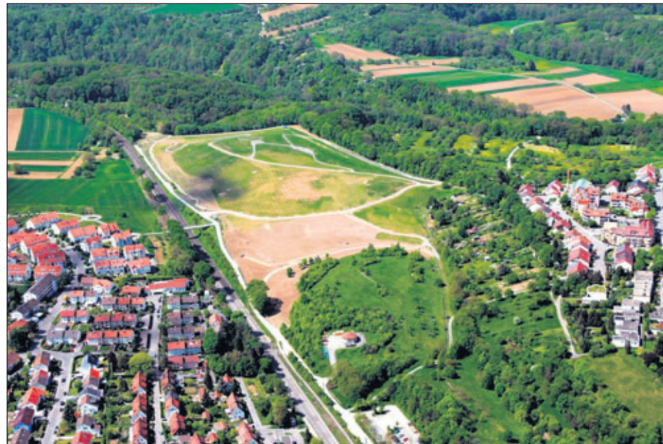
Die Deponie Erbach: links von der Bahnlinie, also südlich, liegt Neustadt-Nord, rechts von ihr und damit nördlich, befindet sich Hohenacker. Bei dem Pavillon in der Mitte der Aufnahme (im unteren Bereich) handelt es sich um den Kontrollschacht für die Deponieentwässerung.
