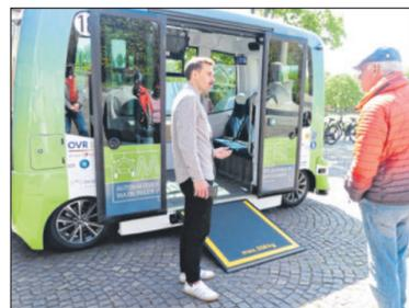
Auf Knopfdruck kann die Rampe am Mini-Bus ausgefahren werden, über die Personen mit Handicap einsteigen können.
