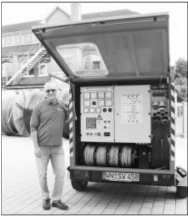
Das neue mobile Notstromaggregat sichert die Stromversorgung bei zum Beispiel geplanten Abschaltungen von Trafostationen. Das Bild zeigt Axel Hamm, den Leiter Management Netze bei den Stadtwerken. Foto: Stadtwerke
