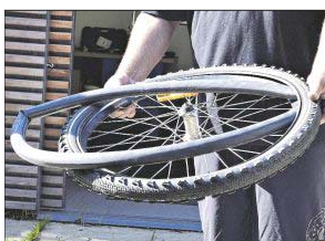
Der Schlauch ist freigelegt.
