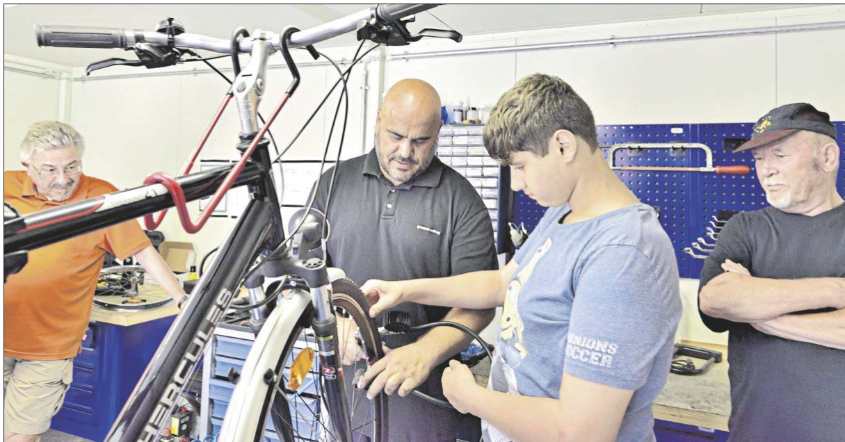
Ein Schützling der Diakonie Stetten pumpt in der Werkstatt den platten Vorderreifen unseres Testrads auf. Tim Sanna prüft danach die Bremsbeläge. Sie sind komplett abgeschliffen.
