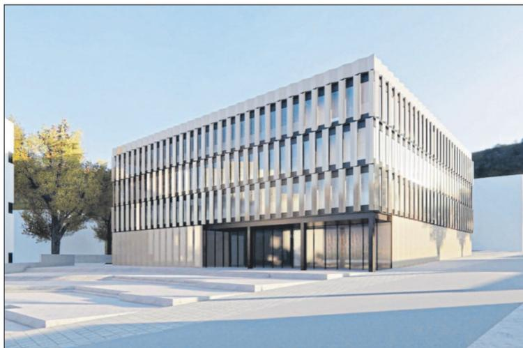
Das neue Amtsgericht in Holzbauweise und mit einer Fassade aus gekanteten Aluminiumlamellen. Ansicht: Heinle, Wischer und Partner
