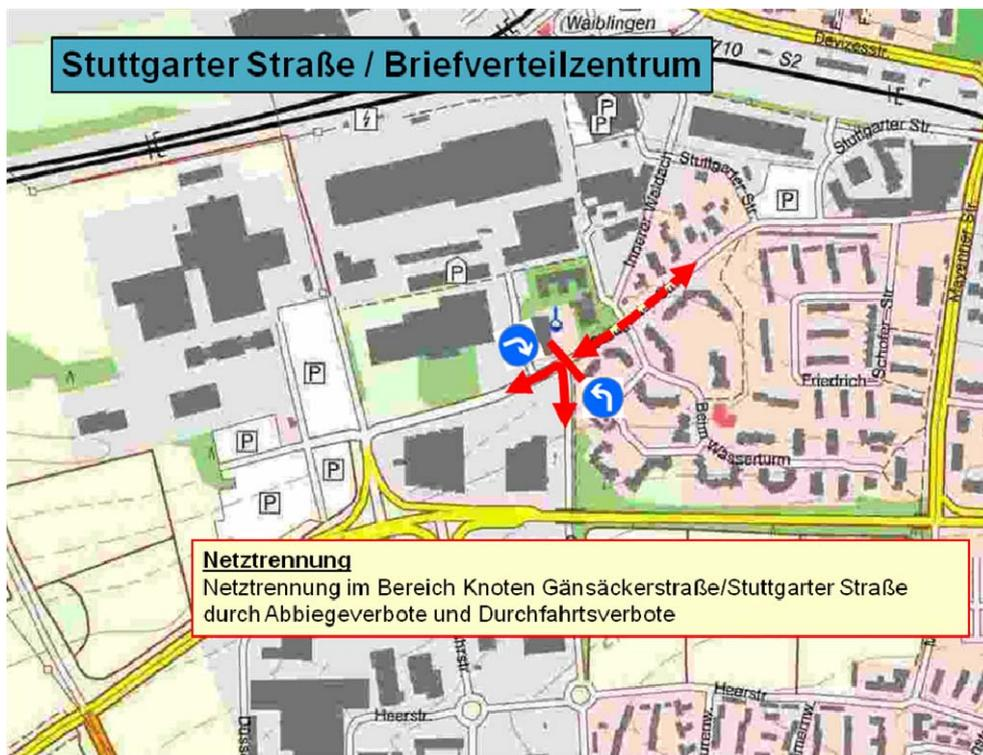
Abbildung 26: Netztrennung Stuttgarter Straße
